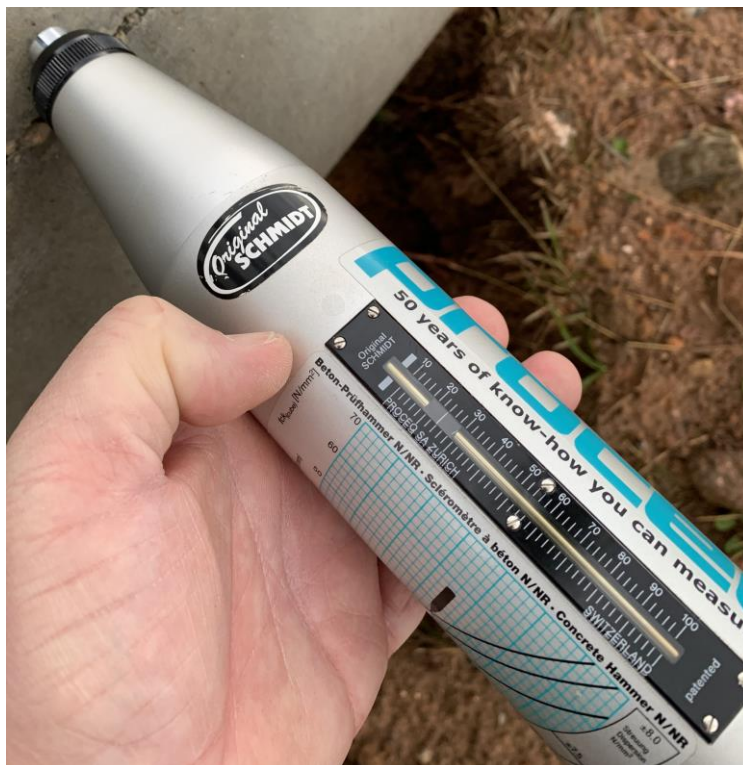
Figura 3b – Esclerômetro Original Schmidt (Proceq)
