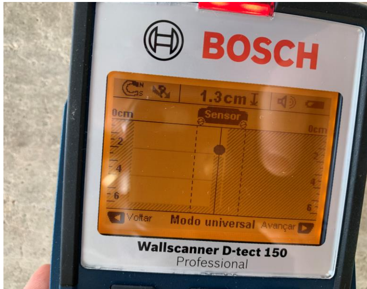
Figura 3a – Investigação da armadura da estrutura com equipamento scanner D-tect 150 Bosch
