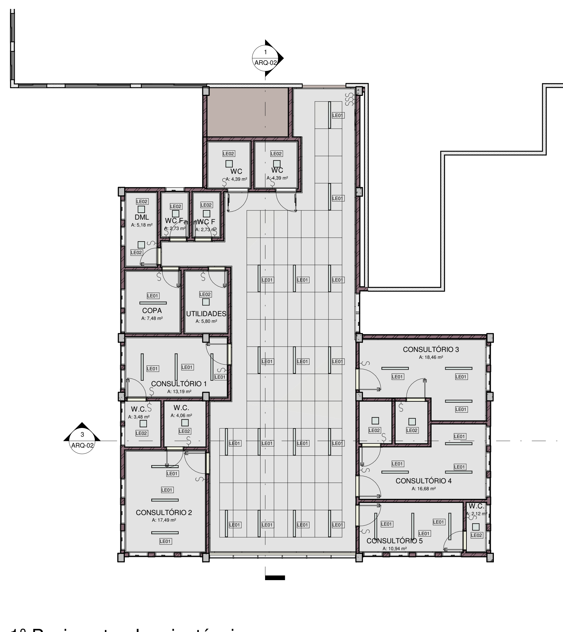
1 1º Pavimento - Luminotécnica 1 : 100
