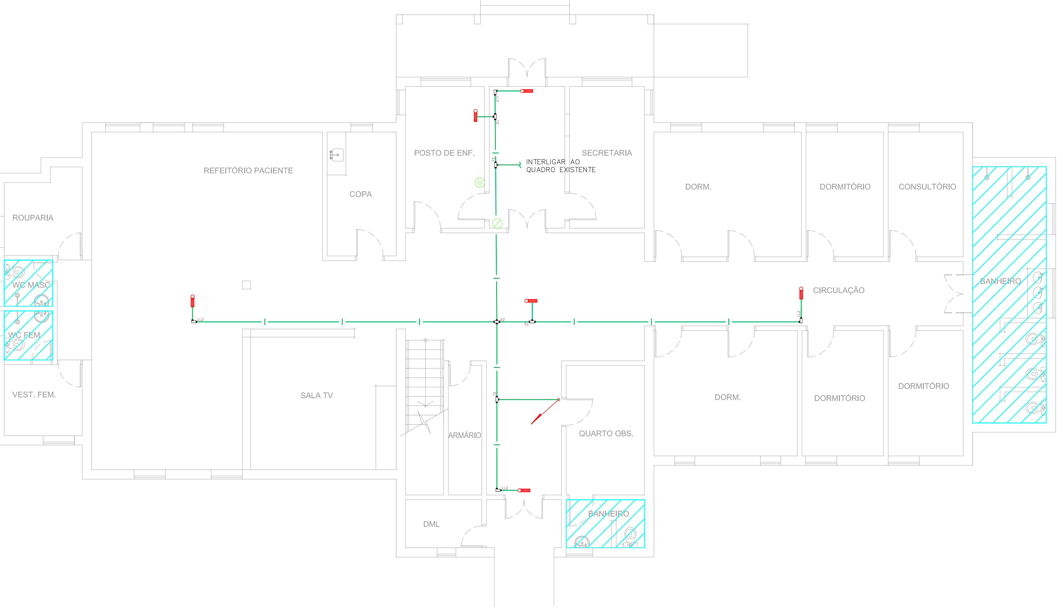
5 CAISM PHILIPPE PINEL - EDIFÍCIO 46 PROJETO BÁSICO DOS SISTEMAS DE INCÊNDIO PLANTA BAIXA - CLÍNICA FEMININA PAVIMENTO TERREIRO ESCALA: 1:75 METRO
