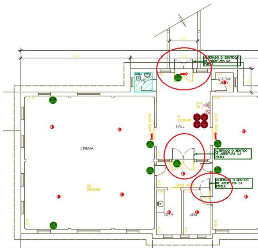
Figura 8 – CAISM – EDIFÍCIO 50 – PAVIMENTO SUPERIOR – Inversão sentido de porta
