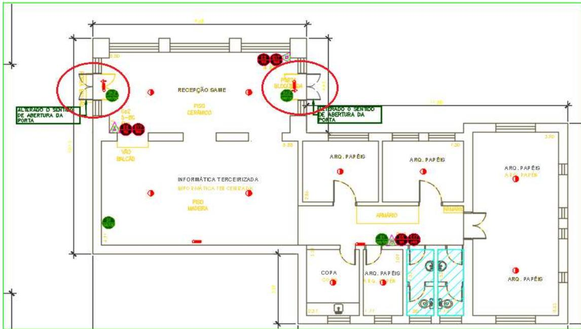
Figura 2 – CAISM – EDIFÍCIO 10 – PAVIMENTO INFERIOR - Inversão sentido de porta
