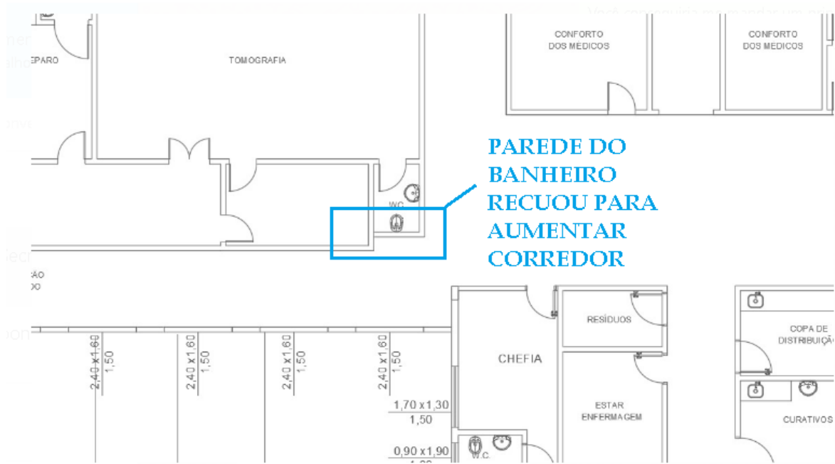
Figura 16 – PAVIMENTO TÉRREO – CORREDOR INTERLIGAÇÃO P.S AO PRÉDIO TOMBADO – Demolição/reconstrução parede
