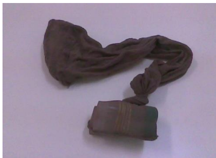
Figura 4 - Tubos criogênicos no interior da meia de nylon.
