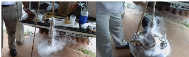
Figura 5 - Tubos criogênicos no interior da meia de nylon inserida no botijão de nitrogênio líquido.
