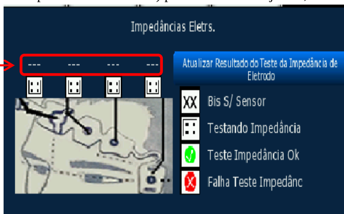
Fig. 10-5 Janela de resultados do teste de impedância do elétrodo
